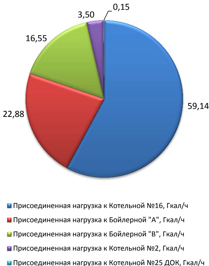
Рисунок 1. Структура распределения присоединенных нагрузок между источниками системы централизованного теплоснабжения Сланцевского городского поселения
